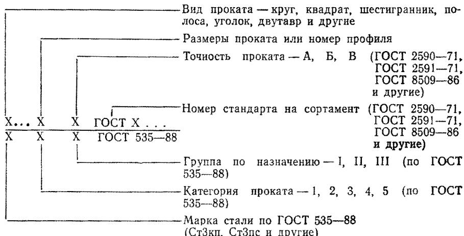
Прокат горячекатанный круглый диаметром 30 мм обычной точности прокатки (В) по ГОСТ 2590—71, марки Ст3сп, категории I, группы II:
